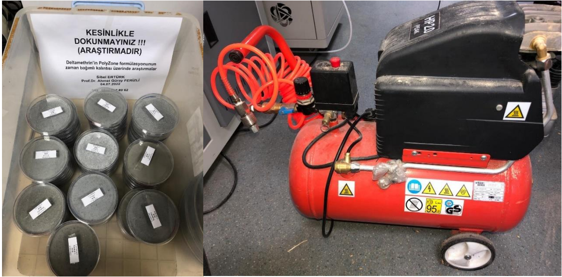
Şekil 3.5 Etiketlenmiş petri kapları ve kaplardaki olası atık ve tozları temizlemede kullanılan kompresörlü hava tabancası
