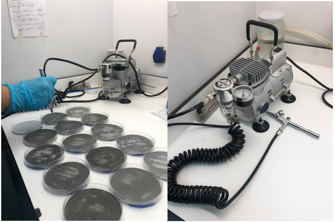
Şekil 3.6 Beton yüzeylere insektisit uygulaması ve hava tabancası
