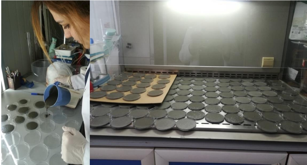
Şekil 3.4 Petri kaplarında hazırlanan beton yüzeyler
