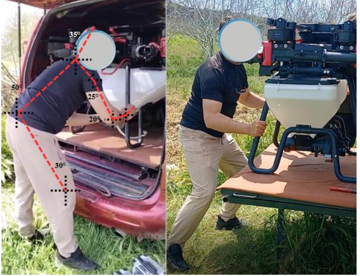
Şekil 4.6 İHA araca yerleştirilirken
