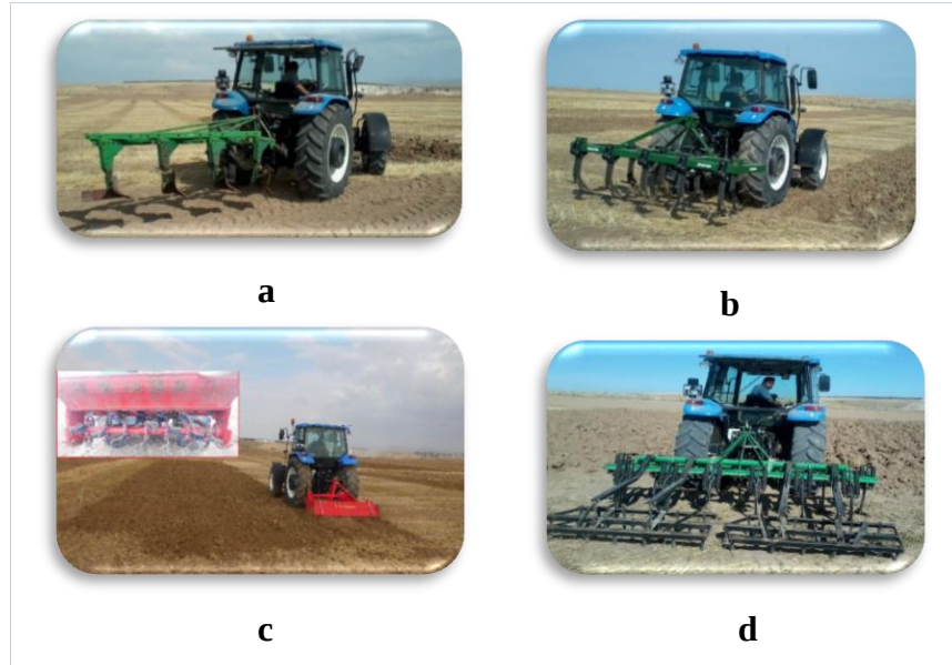
Şekil 3.6 Kullanılan toprak işleme alet-makinelerine ait görseller (a kulaklı pulluk, b çizel, c rotovator, d kazayağı-tırmık takımı)
