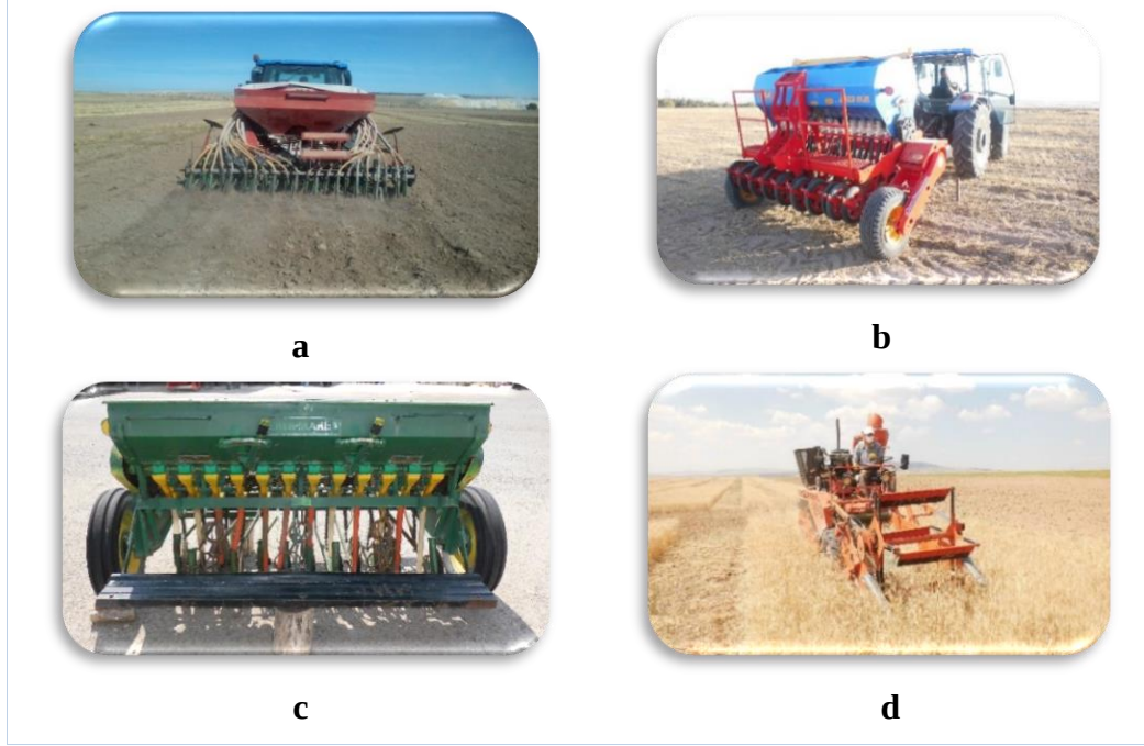
Şekil 3.7 Kullanılan ekim ve hasat makinelerine ait görseller (a kombine pnömatik, b anıza ekim, c kombine mekanik ekim makinesi, d parsel biçerdöveri)
