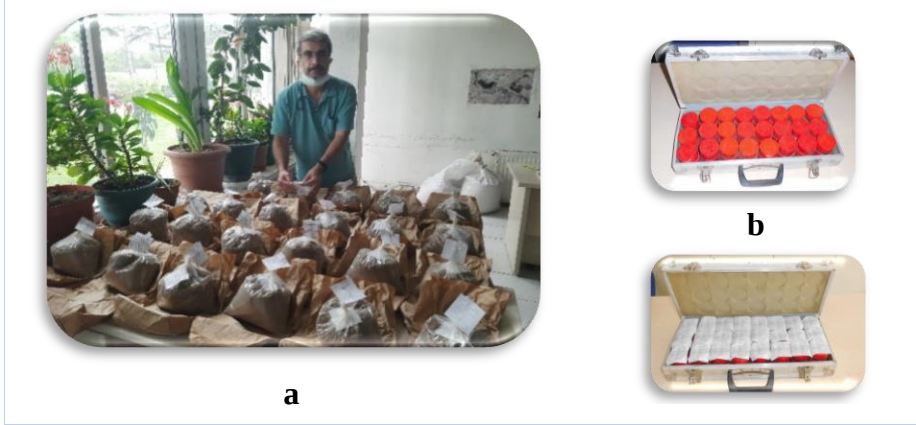
Şekil 3.21 Toprak örneği hazırlama çalışmalarından fotoğraflar (a bozulmuş, b bozulmamış toprak örnekleri)
