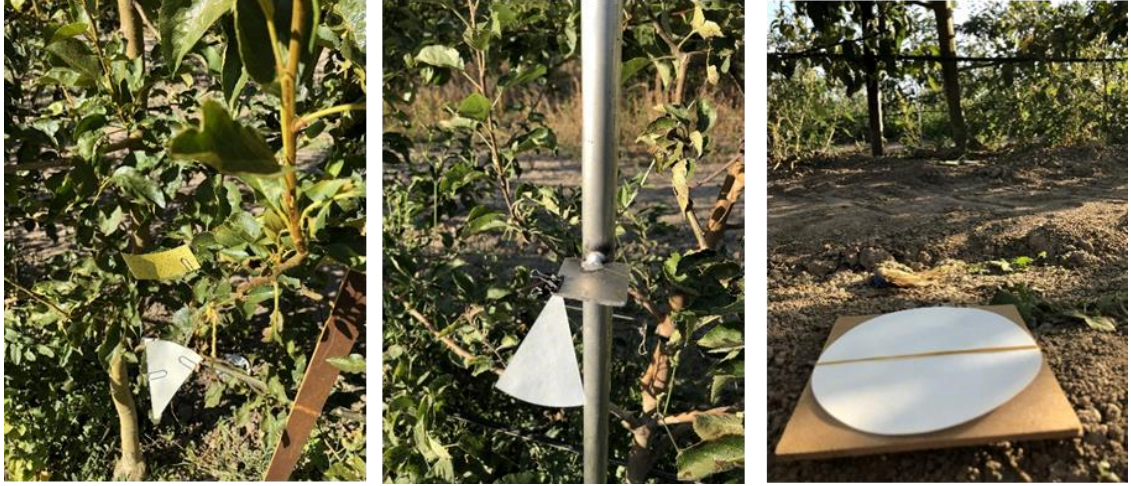
Şekil 3.11 Denemelerde kullanılan suya duyarlı kart ve filtre kağıtları
