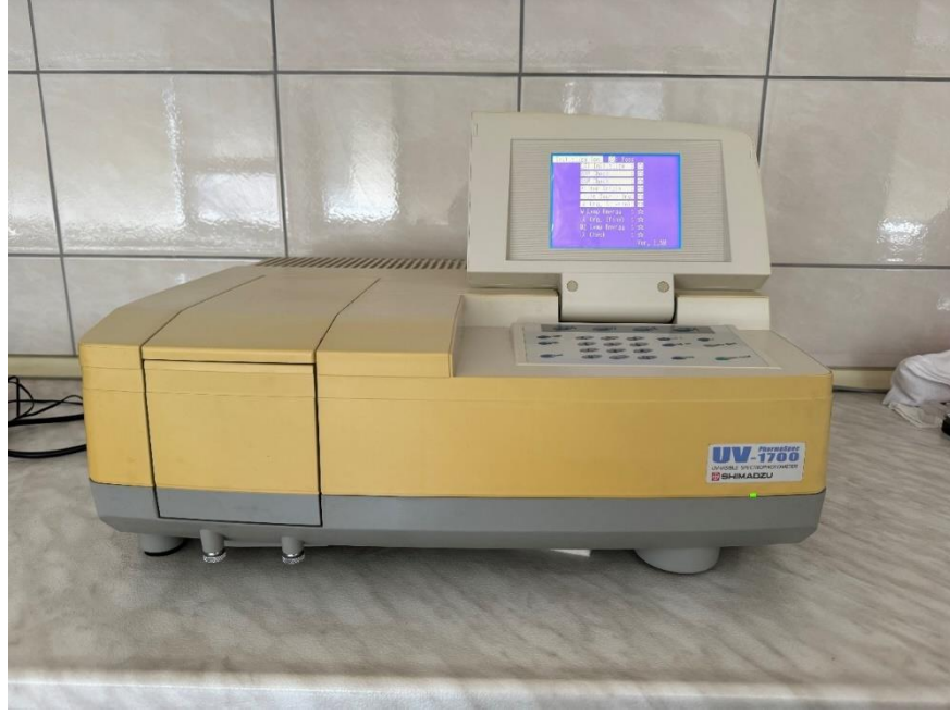
Şekil 3.7 Kalıntı analizlerinde kullanılan Shimadzu UV-VIS 1700 spektrofotometre
