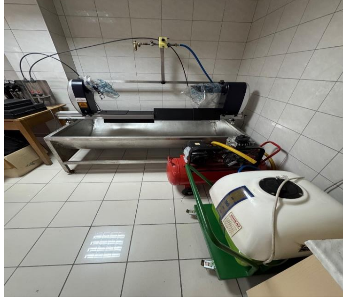
Şekil 3.8 Damla çapı ölçüm sistemi
