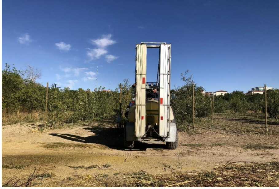
Şekil 3.2 Denemelerde kullanılan kule tip pülverizatör
