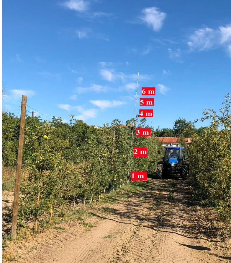
Şekil 3.14 Havaya sürüklenme ölçümlerinde kullanılan örnekleme direği
