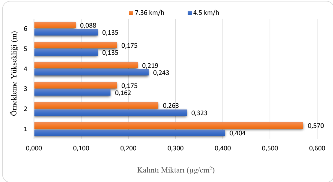
Şekil 4.16 Kule tip pülverizatör ve konvansiyonel Albuz ATR meme ile çalışmada farklı ilerleme hızlarında sürüklenmeyle oluşan kalıntı miktarlarının örnekleme yüksekliğine göre değişimi (Hava akım hızı: 19.95 m/s, Basınç:10 Bar)
