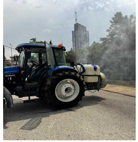
Şekil 3.1 Denemelerde kullanılan konvansiyonel yardımcı hava akımlı pülverizatör
