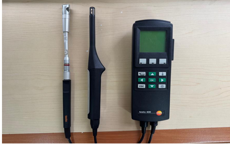
Şekil 3.9 Pülverizatör hava akım hızı ve meteorolojik verilerin ölçülmesinde kullanılan Testo 400 ölçüm cihazı
