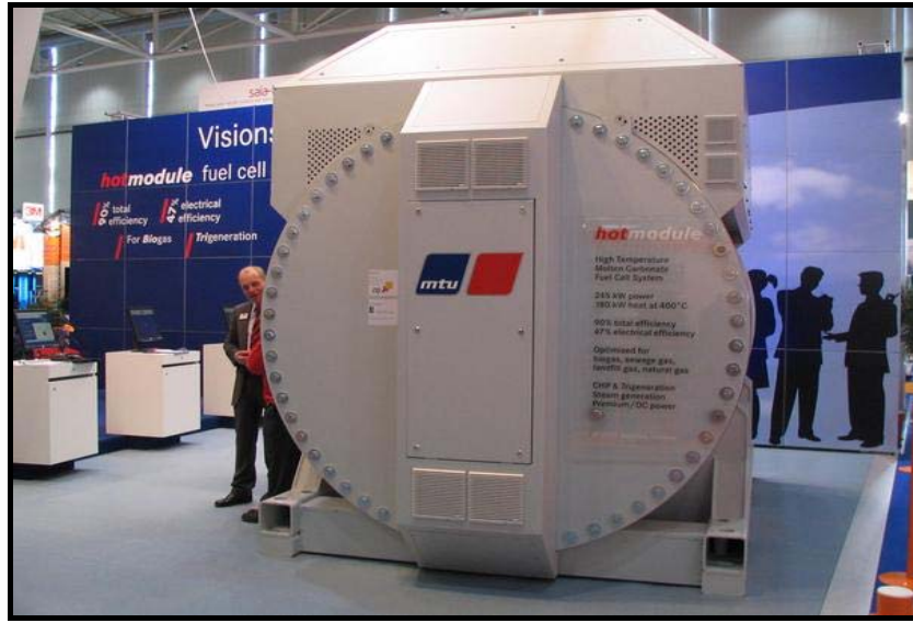
Şekil 2.46 Almanya'da işletilmekte olan biyogaz için yakıt pili (Anonymous 2011f)
