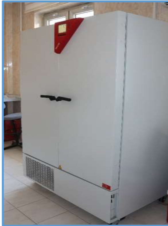
Şekil 3.21 Biyoloji takibi çalışmalarında kullanılan elektronik kontrollü İklim kabini
