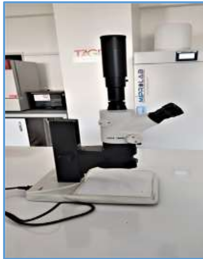
Şekil 3.2 Leica S8 Apo Stereo mikroskop
