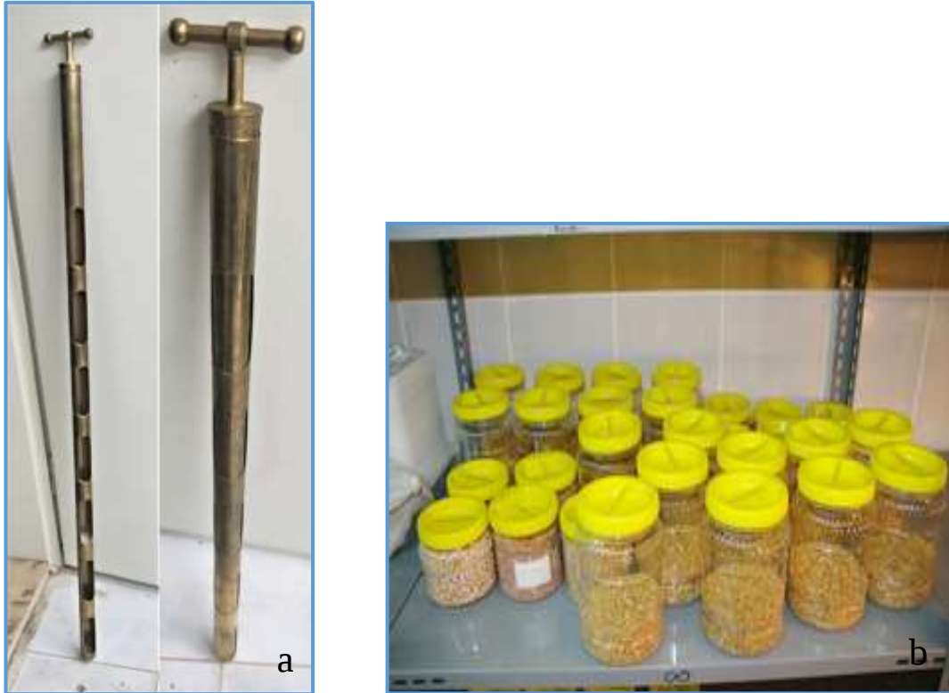
Şekil 3.12 Örneklemelerde kullanılan yığın sondaları (a) ve örnek kapları (b)
