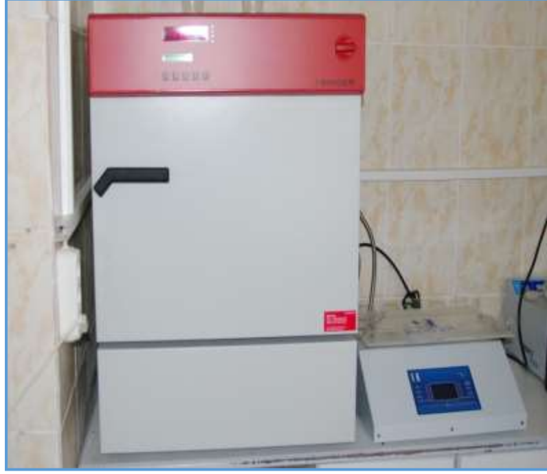
Şekil 3.18 Preparatların kurutulmasında kullanılan sıcaklık kontrollü etüv
