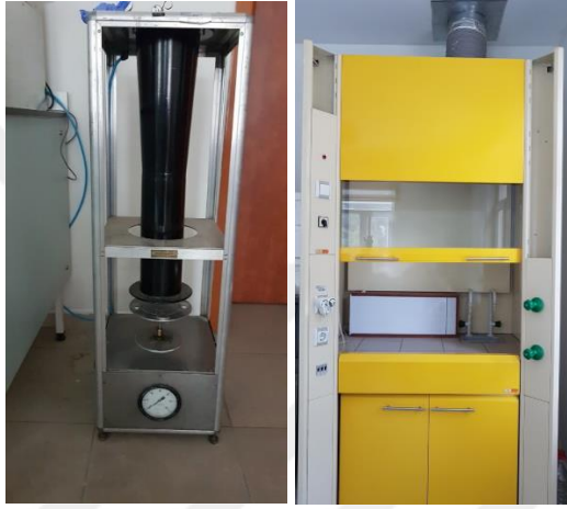
Şekil 3.8 İlaç püskürtmesinde ve kurutulmasında kullanılan ilaçlama kulesi ve çekerocek
