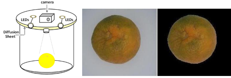
Şekil 2.30 Çalışmada kullanılan özel tasarlanmış kutu ve portakaldan alınan görüntü (Jhawar 2016)
