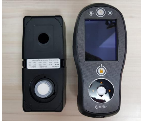
Şekil 3.3 Denemelerde kullanılan spektrofotometre ve kalibrasyon plakaları
