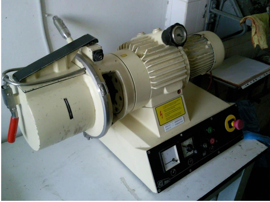
Şekil 3.1 Araştırmada ön karışımın hazırlanmasında kullanılan 3 Kg kapasiteli Lödige marka mikser
