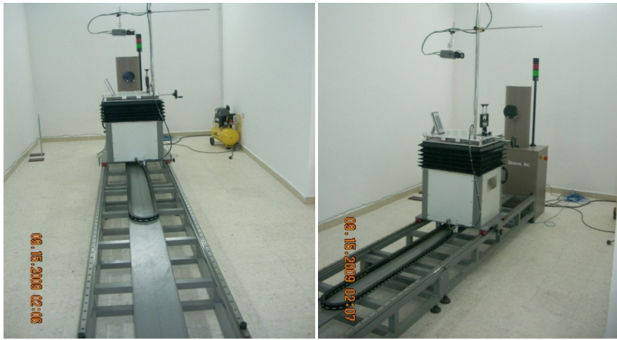
Şekil 3.16 Ankara Üniversitesi Nükleer Bilimler Enstitüsü'nde kurulmuş olan ^{137}\text{Cs} foton kaynağı ışınlama sistemi
