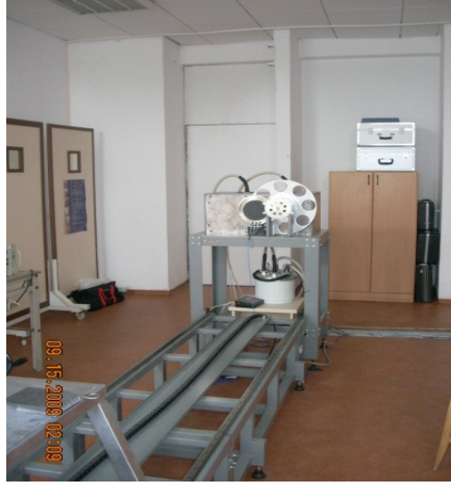
Şekil 3.17 Ankara Üniversitesi Nükleer Bilimler Enstitüsü'nde kurulmuş olan X-ışını kalibrasyon sistemi
