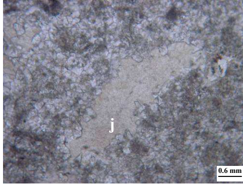
Şekil 4.6 GA-6 no'lu sparitik kireçtaşı örneği içerisindeki jips (j) gelişimlerinin tek nikol görünümü
