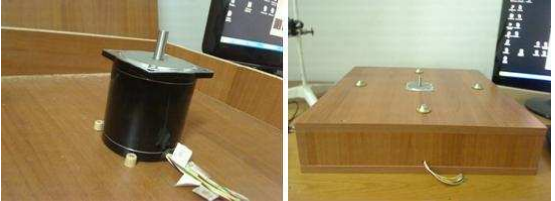
Şekil 3.3 Motor haznesi açık (solda) ve kapalı (sağda) olarak
