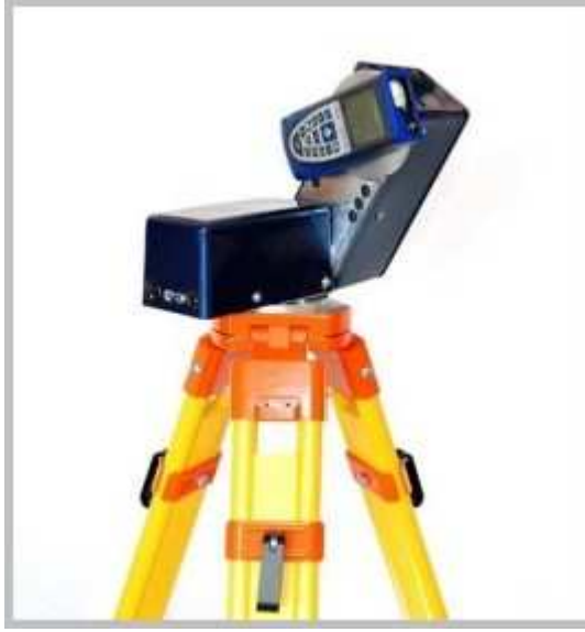
Şekil 1.11 Bir lazer mesafe ölçer
