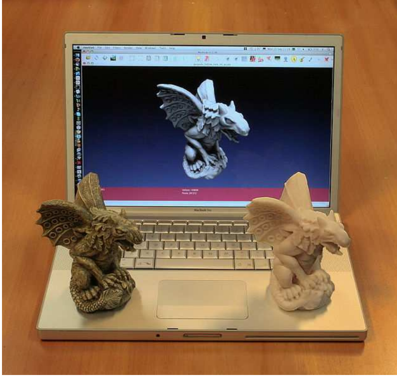
Şekil 1.5 Örnek bir nesnenin 3B tarama ve 3B yazdırma ile oluşturulan kopyası
