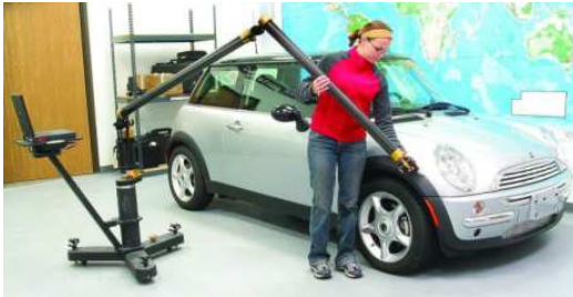
Şekil 1.10 Temasa dayalı bir tarayıcı örneği
