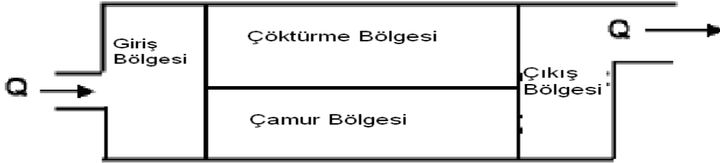
Şekil 2.2 Çöktürme havuzunun fonksiyonel bölgeleri (Fornshell 2001).
