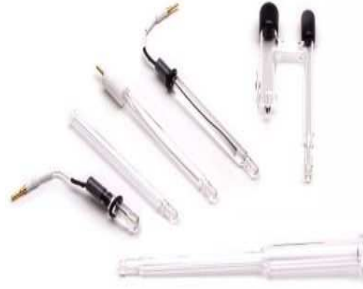
Şekil 3.4 BAS Model Ag/Ag + elektrotlar (içinde asetonitril içinde 0,1 M TBATFB olan dolgu çözeltisi)
