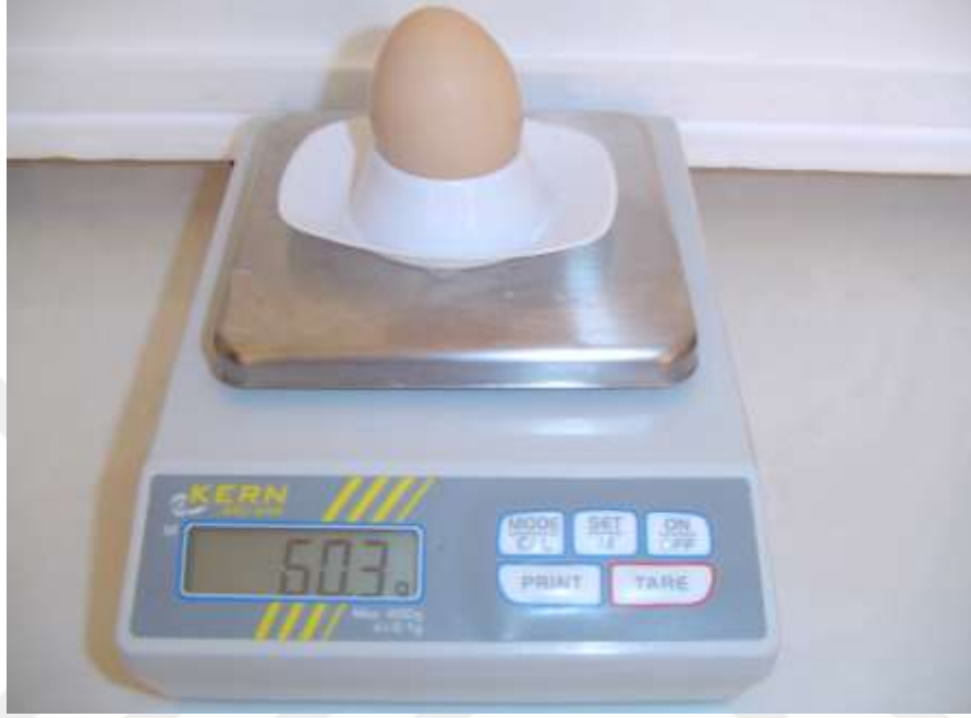
Şekil 3.1 Yumurta ağırlığı ölçüm terazisi
