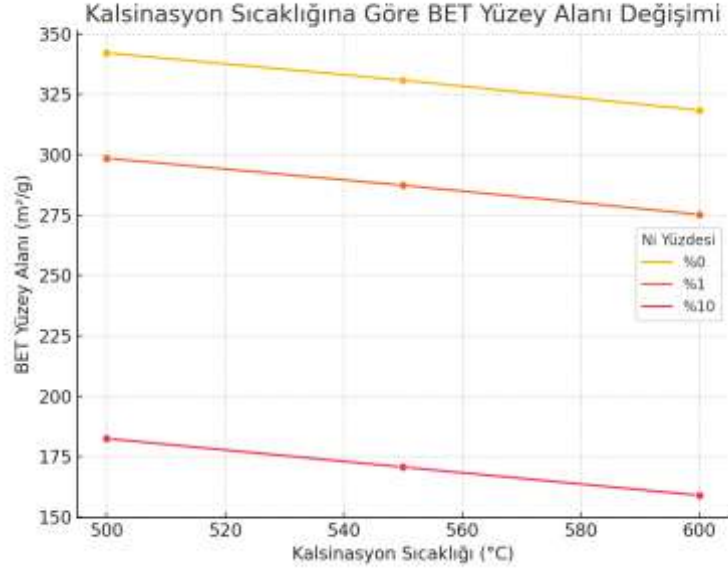
Şekil 4.7 Farklı nikel yüklemelerine sahip katalizörlerde kalsinasyon sıcaklığına bağlı olarak değişen BET yüzey alanı değerleri
