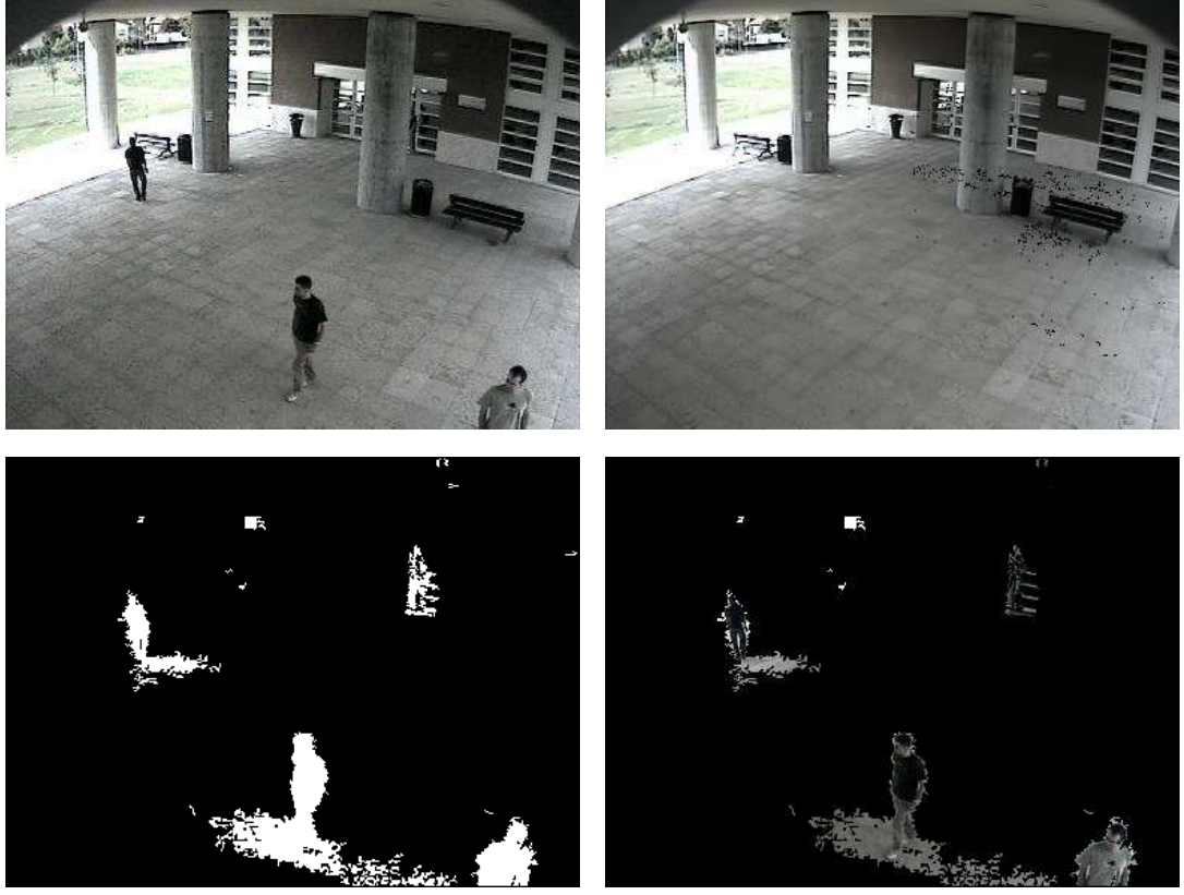
Şekil 6.2 Video1 için Gauss karışımları yöntemiyle elde edilen sonuçlar Sol üst orijinal görüntü, Sağ üst arka plan görüntüsü, Sol alt ön plan maskesi, Sağ alt ön plan görüntüsü
