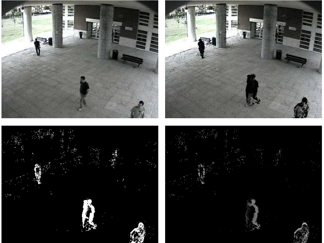
Şekil 6.1 Video1 için çerçeve farkı yöntemiyle elde edilen sonuçlar Sol üst orijinal görüntü, Sağ üst arka plan görüntüsü, Sol alt ön plan maskesi, Sağ alt ön plan görüntüsü
