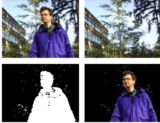
Şekil 6.11 Video3 için kutu tabanlı kod çizelgesi yöntemiyle elde edilen sonuçlar Sol üst orijinal görüntü, Sağ üst arka plan görüntüsü, Sol alt ön plan maskesi, Sağ alt ön plan görüntüsü
