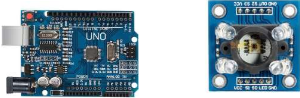
Şekil 3.5 Cihaz tasarımında kullanılan Arduino mikrodenetleyici kartı ve RGB sensör görüntüleri
