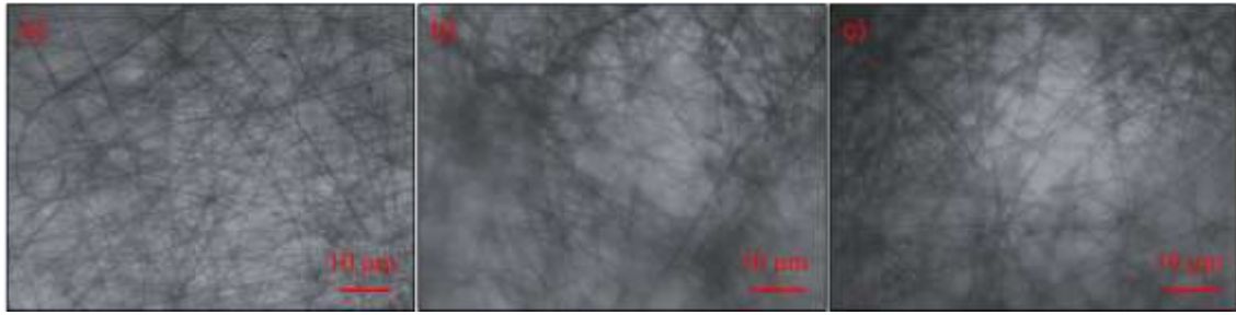
Şekil 5.25 Üç farklı derişimdeki P2OX'un jelatin ile harmanlanmış elektroğirilmiş liflerin optik mikroskop görüntüleri (a) %5, (b) %10 ve (c) %15
