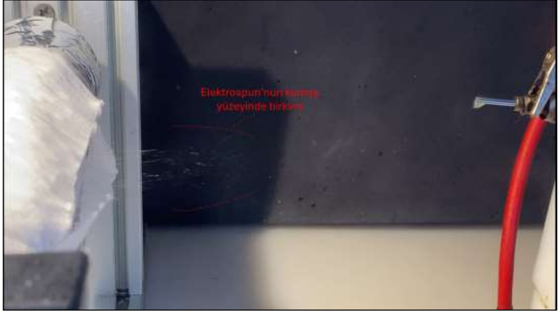
Şekil 5.34 WBPU4 elektrospun'nun pamuk kumaş yüzeyinde birikimi
