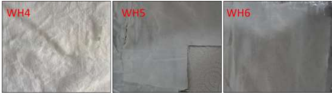
Şekil 5.38 WBPU ile ayrı ayrı P2Ox, P2Ox -ko-PEI ve LPEI polimerlerinin elektroğirme işlemiyle elde edilmiş nanolifli ağ yapıların pamuk kumaş yüzeyine kaplanmasına ait dijital görüntüler
