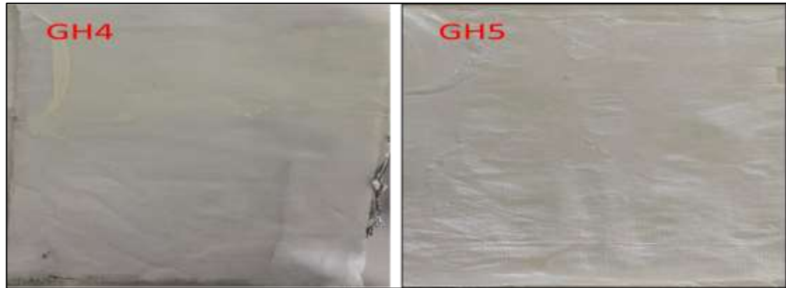
Şekil 5.26 Pamuk kumaş yüzeyine kaplanmış jelatin ile P2Ox (GH4) ve P2Ox-ko-PEI'nin (GH5) hibrit yapıdaki digital görüntüleri
