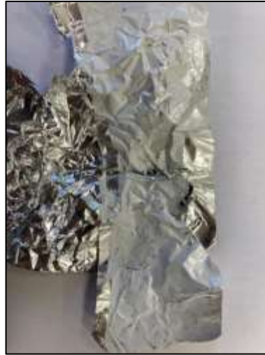
řekil 5.31 PEG (Mw: 1000) kullanılarak sentezlenen WBPU polimerinin klorofom ortamında hazırlanmış %20'lik özeltisinden harmanlanmış karıřım morfolojisinde Al folyo üzerine elektroęirilmiş kaplamanın görüntüsü (elektropüskürme řeklinde oluřtuęu düşünölmektedir)
