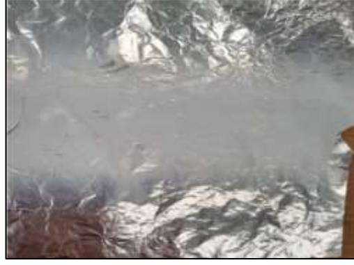
Şekil 5.6 Elektro-püskürme halinde yüzeyde birikime
