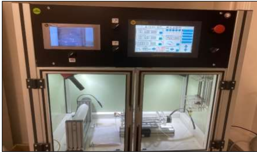
Şekil 4.4 Lif üretiminde kullanılan yarı-endüstriyel elektroęirme cihazı
