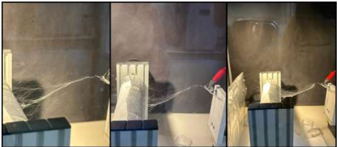
Şekil 5.47 Elektroğirmeye kullanılan çekirdek-kabuk (core-shell) karışımın genel düzeneğinin fotoğrafik görüntüsü
