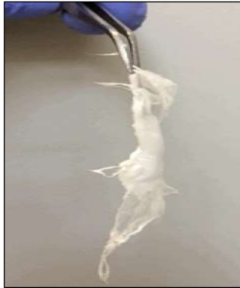
Şekil 5.8 Elektroğirilmiş jelatin kaynaklı lif
