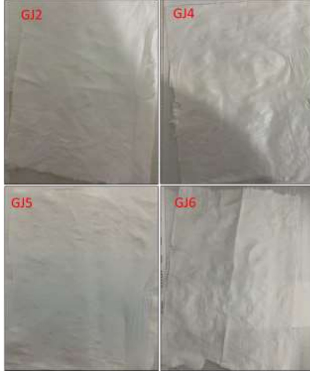
Şekil 5.42 Kumaş yüzeyine elektroğrılmış çift-yüz formundaki liflerin dijital görüntüleri
