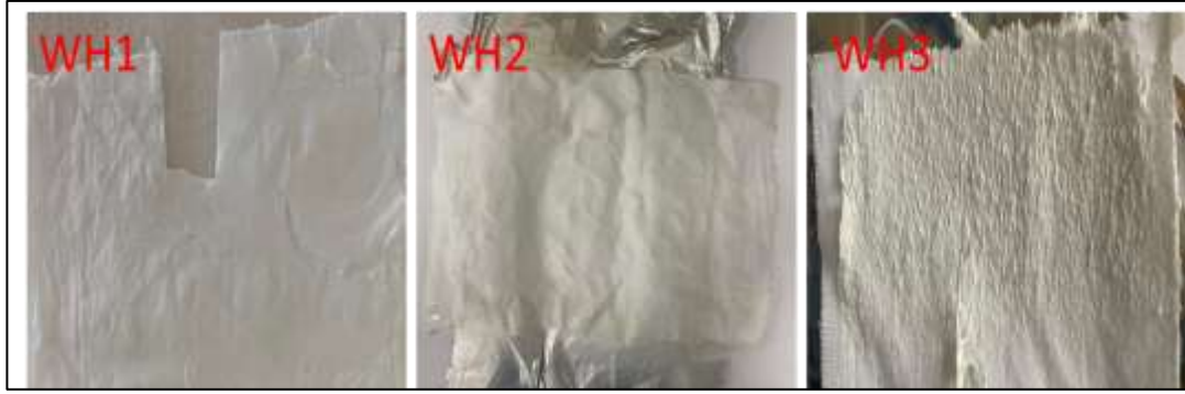
Şekil 5.37 WBPU ve BPEI polimerlerinin üç farklı moleküler kütlelerine ( M_n=800, 1800, 10000 ) sahip nanolifli ağ yapıların kumaş yüzeyine kaplanmasının dijital görüntüleri
