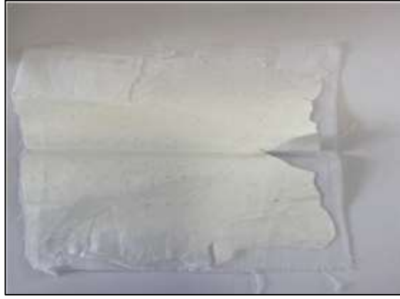
řekil 5.15 Elektroėirilmiş lifin kumař yüzeyinden kavlaması
