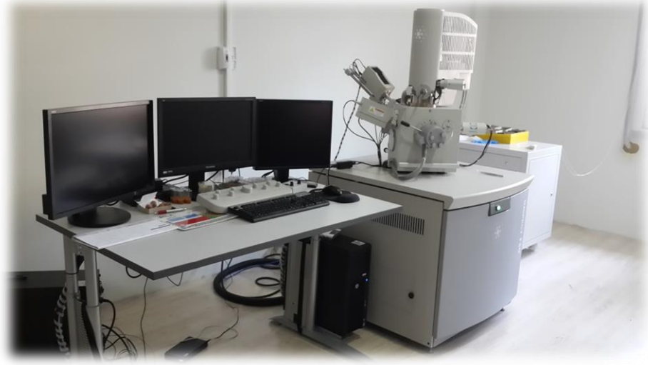
Şekil 3.3 FEI INSPECT F50 model FEG filamentli SEM cihazı
