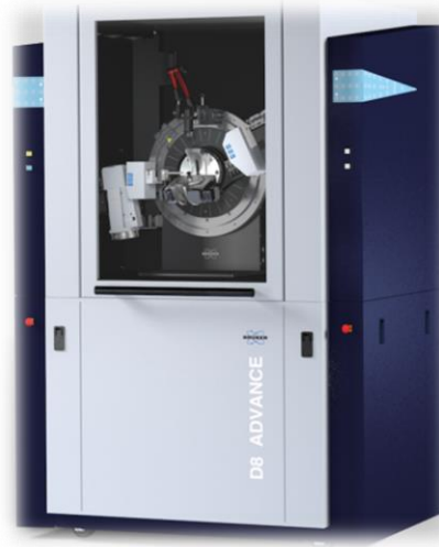
Şekil 3.2 LynxEye Xe-T dedektörlü Bruker D8 Advance XRD cihazı
