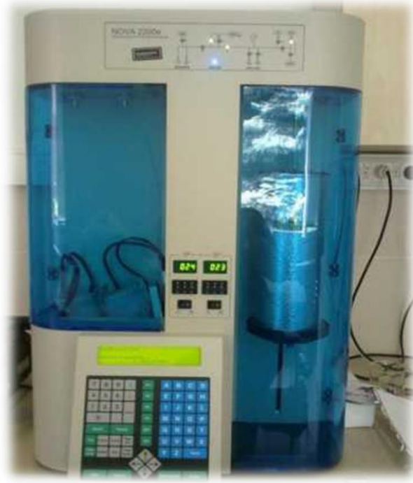
Şekil 3.4 Quantochrome-Nova 2200e BET cihazı
