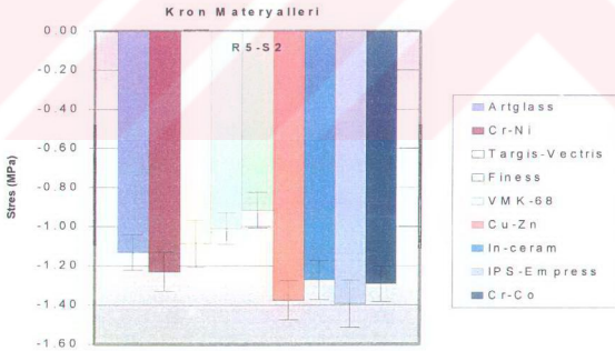
Şekil 3.5. Kronların R5-S2 rozet gauge için minimum principal stres değerleri
