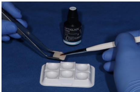
Şekil 2.16. Optiglaze Şeffaf uygulanan örneklerin ışıkla polimerizasyonu
