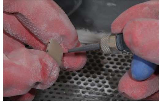
Şekil 2.14. Örneklerin kumlama cihazı ile kumlanması
