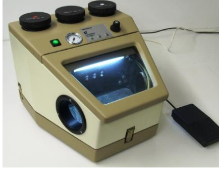
Şekil 2.14. Örneklerin kumlama cihazı ile kumlanması
