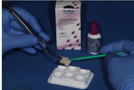
Şekil 2.15. Hibrit yapıdaki örnek yüzeylerine primer uygulaması
