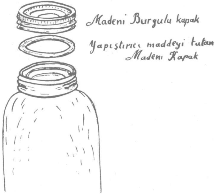
Şekil (8): İki parçalı madensel kapaklı standard MASON cam kabı. Literatür (65) den alınmıştır.
