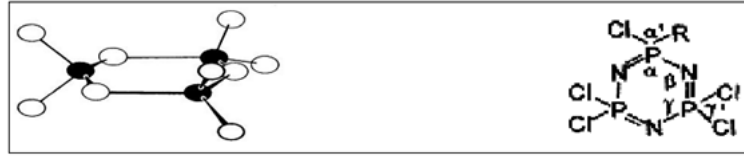
Şekil 2.17 Siklotrifosfazenin yapısı ve bağ açılarının gösterimi
