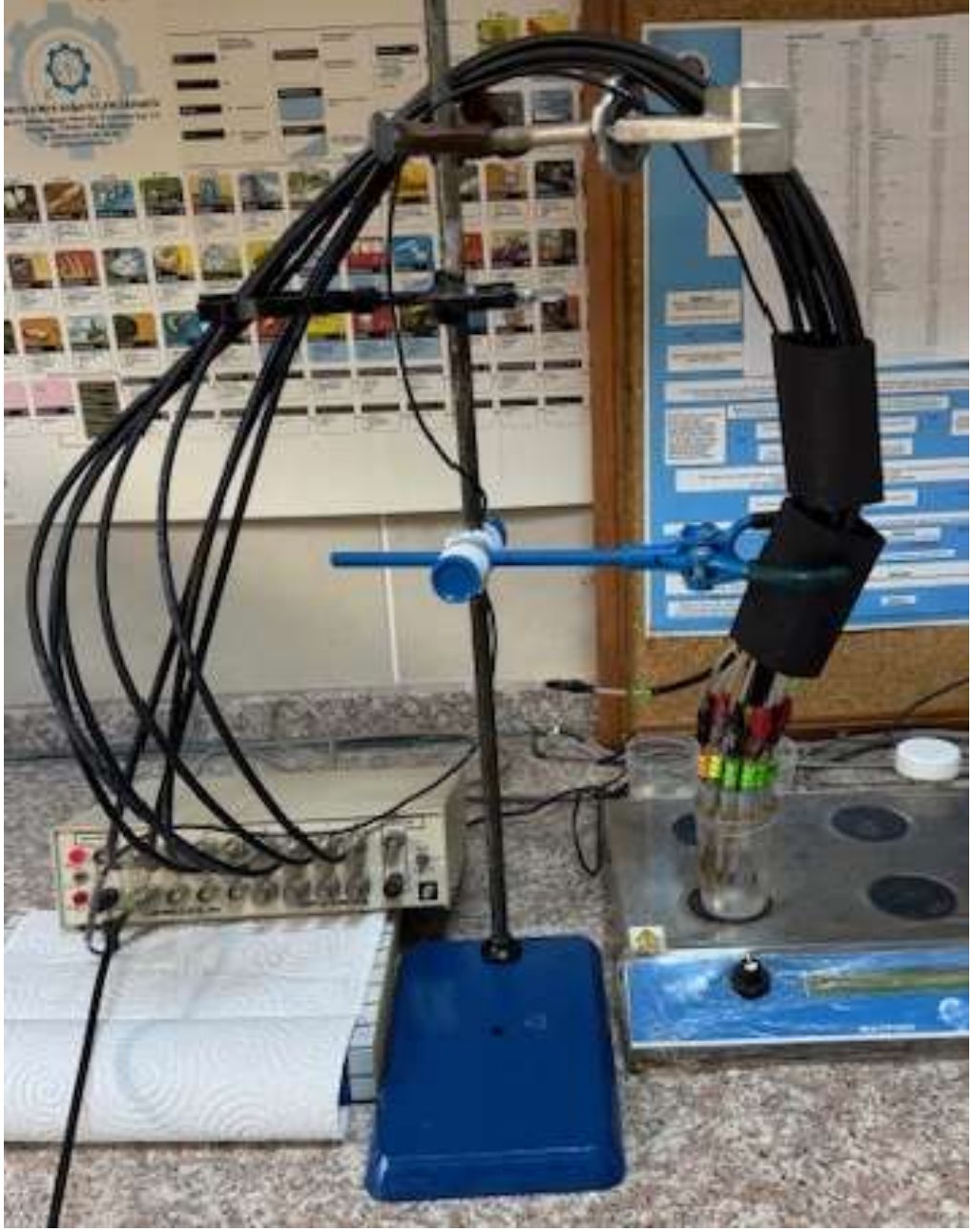
Şekil 4.1 Potansiyometrik ölçümlerde kullanılan deney düzeneği
