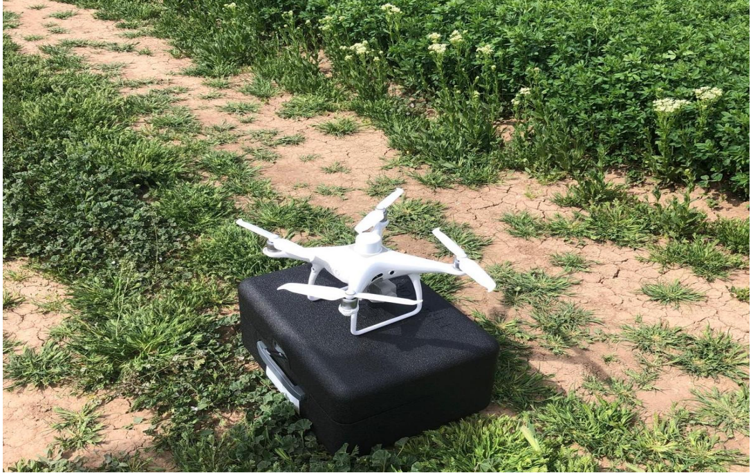
Şekil 3.2 Araştırmada kullanılan multispektral kameralı İHA
