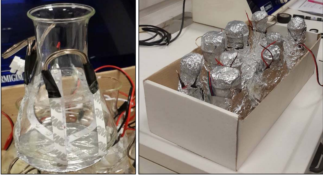
Şekil 3.2 Her bir dalga boyu için hazırlanan aydınlatma sistemleri
