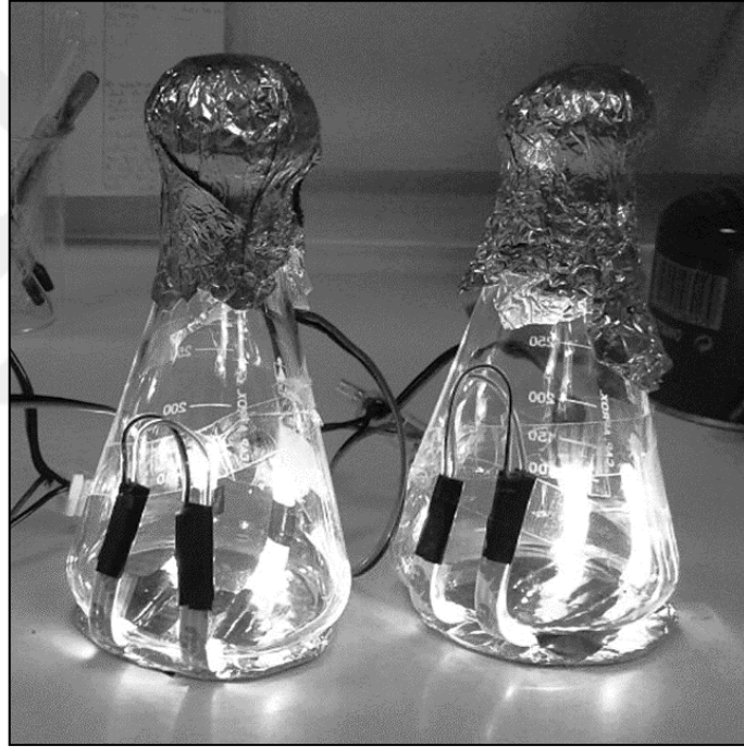
Şekil 3.1 El yapımı algal kültürasyon prototipi
