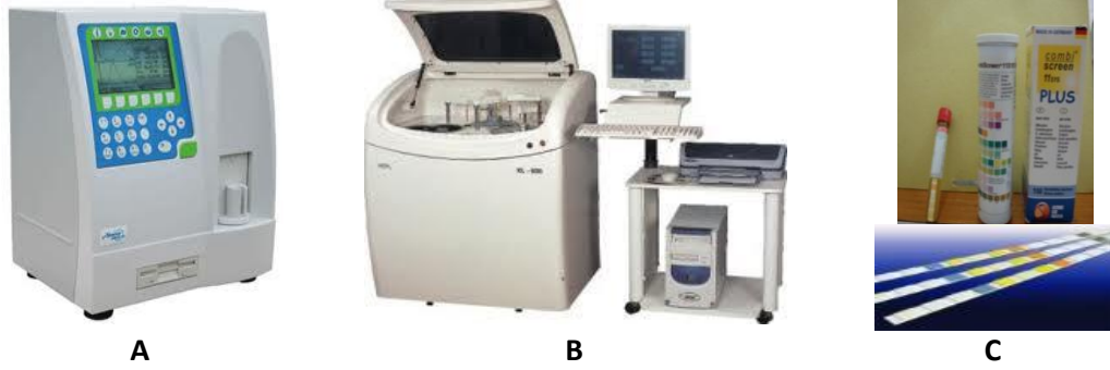
Şekil 2.10.1. Laboratuvar analiz aletleri. A) Abacus Junior Vet kan sayım cihazı, B) Erba® XL – 600 kan biyokimya otoanalizör, C) Combi® screen 11 sys plus.
