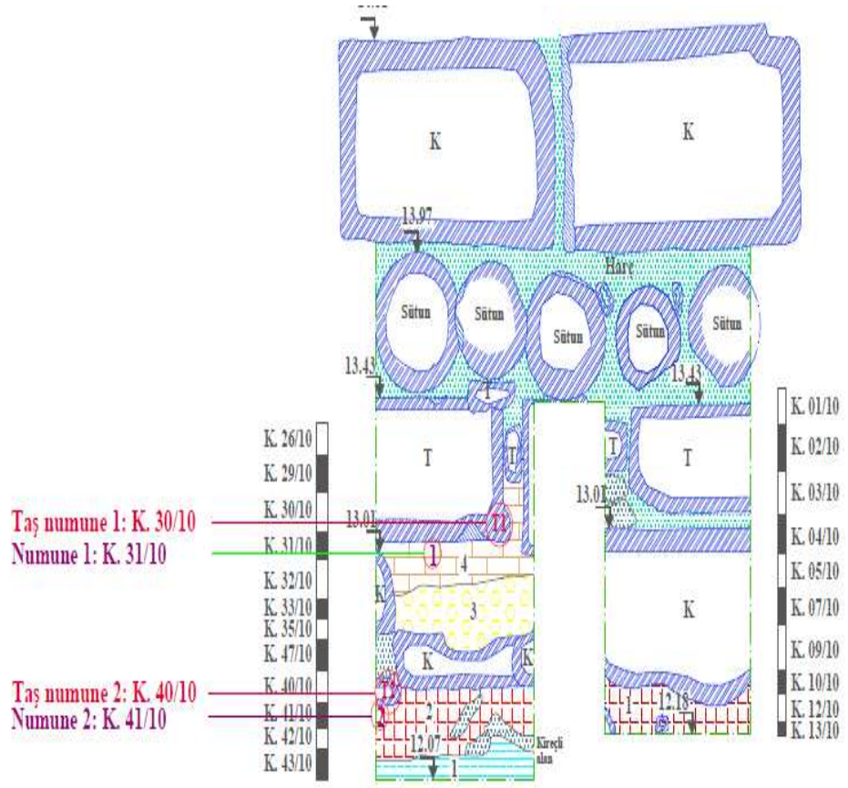
Şekil 1.3 Örnek alınan 2a-10 kesiti görülmektedir.1 ve 2 rakamları ile tanımlanan yerlerden karotlar ile toprak örnekleri alınmıştır
