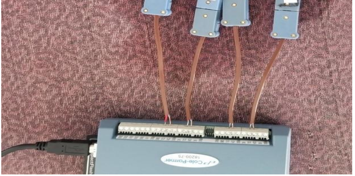
Şekil 3.2 Sıcaklık ölçüm deneylerinde kullanılan veri toplama sistemi
