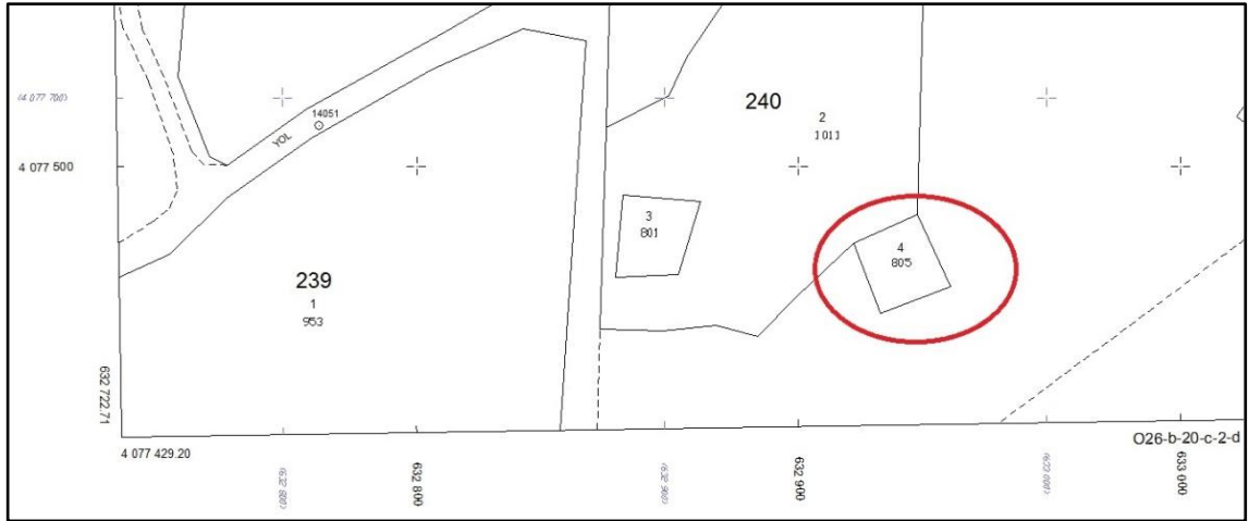
Şekil 2.2 Teknik nedenlerle yetersiz kalan bir kadastro paftasının 22-a ile yenilenmiş (1/1000 ölçekli Manavgat/Ulukapı O26-B-20-C-2-A paftası)
