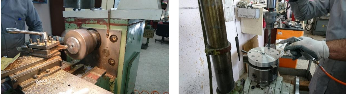
Şekil 4.8 Demet İletim Hattı 1.1'in sonuna monte edilen flanj bütünüünün imalat aşamalarından kesitler
