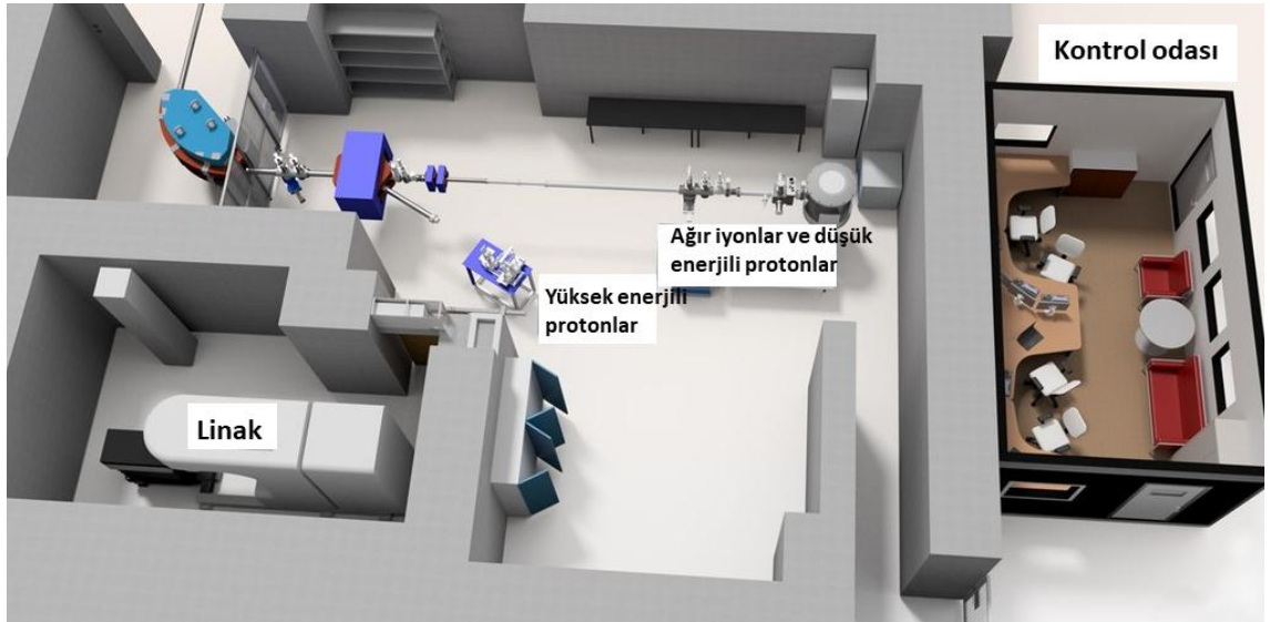
Şekil 2.2 Jyvaskla (Finlandiya)'daki 18-30 MeV enerjili siklotronun RADEF ünitesi ve Ar-Ge maksatlı ağır iyon hattı
