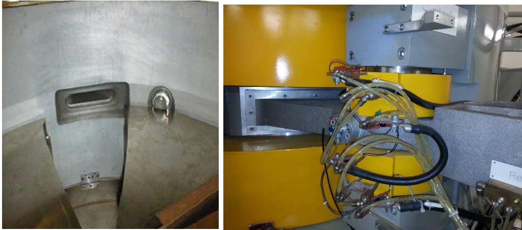
Şekil 3.11 Cyclone® 30 hızlandırıcısının kavite içindeki demet çıkış noktasının (solda) ve demeti kavite dışına bükten dâhili dipol mıknatısın (sağda) görünümü
