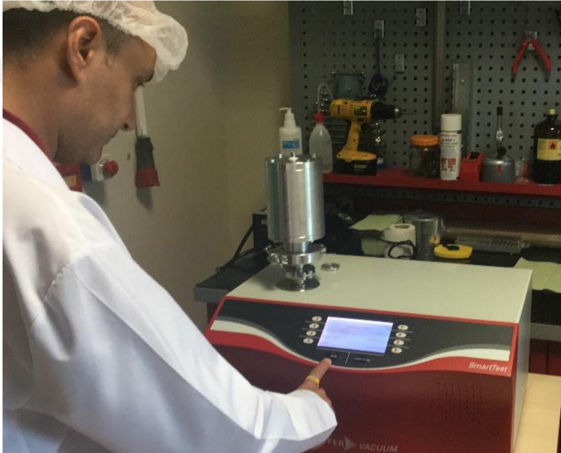
řekil 4.29 Faraday kabı iin He kaak dedektr ile yapılan vakum sızdırmazlık testinden grnm
