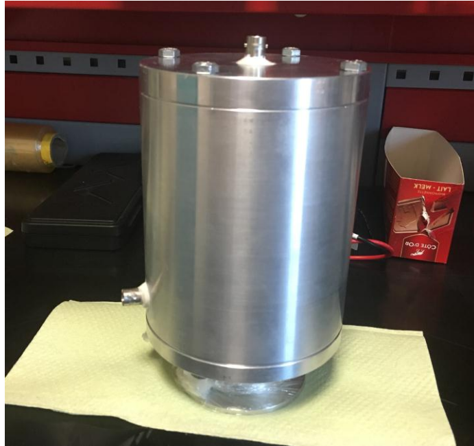
Şekil 4.28 Vakum sızdırmaz olarak tümlenme işlemi tamamlanan Faraday kabın görünümü
