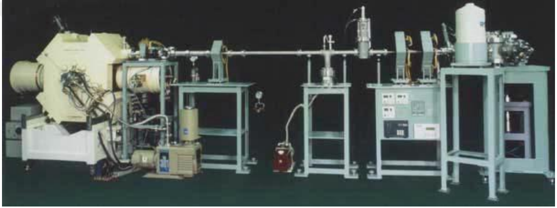
Şekil 2.8 Nishina Memorial Cyclotron Center (Japonya) bünyesindeki PIXE ve RBS çalışmaları için kullanılan demet hattı ve deney istasyonu
