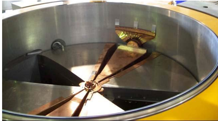
Şekil 3.5 Cyclone® 30 hızlandırıcısının üst ve alt kavitesi ve Dee'lerin görünümü
