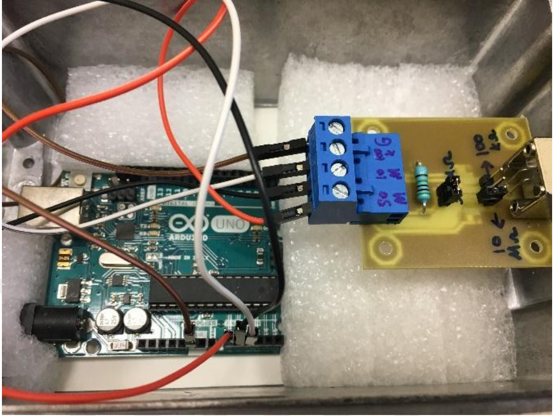
Şekil 4.31 Akım ölçüm sistemi elektronik ölçüm ünitesinin görünümü
