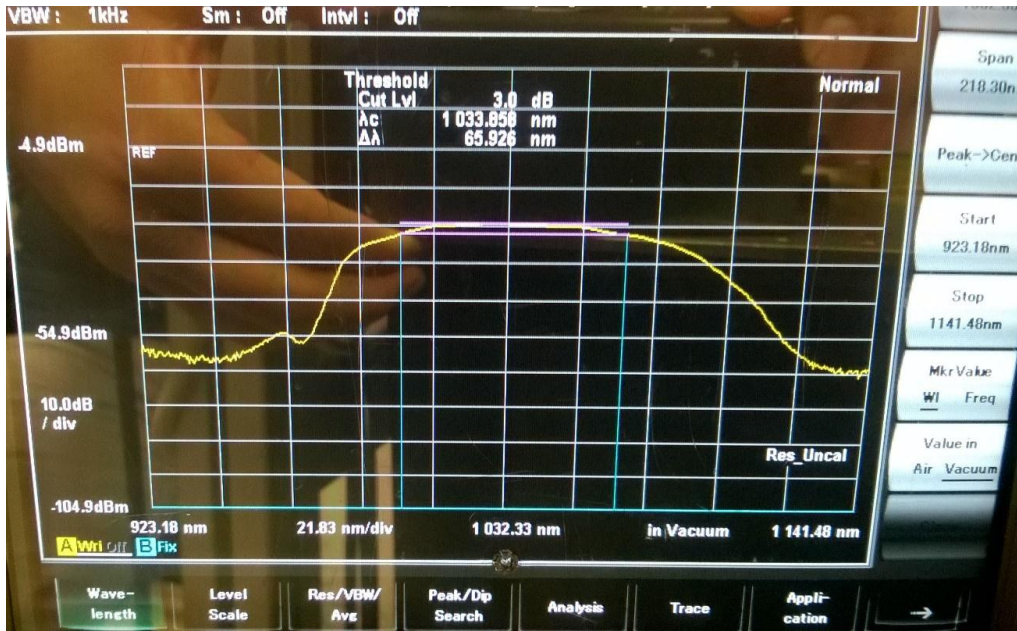
Şekil 4.3 Polarizasyon kontrol ediciler hareket ettirilerek bulunan daha kararlı hal
