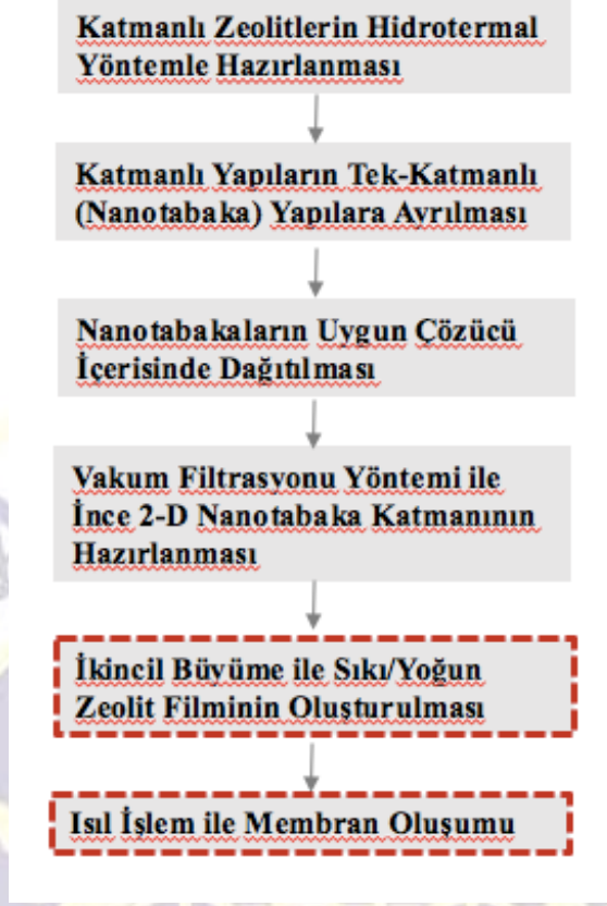
Şekil 1. Zeolit membranların hazırlanma aşamaları.
