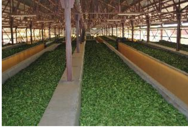
Şekil 2.2 Soldurma aşaması (biriz.biz/cay/cayliteraturuindex.htm 2017)
