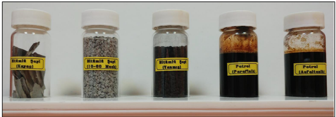
Şekil 3.5 Bitümlü şeyl retortlama aşamaları
