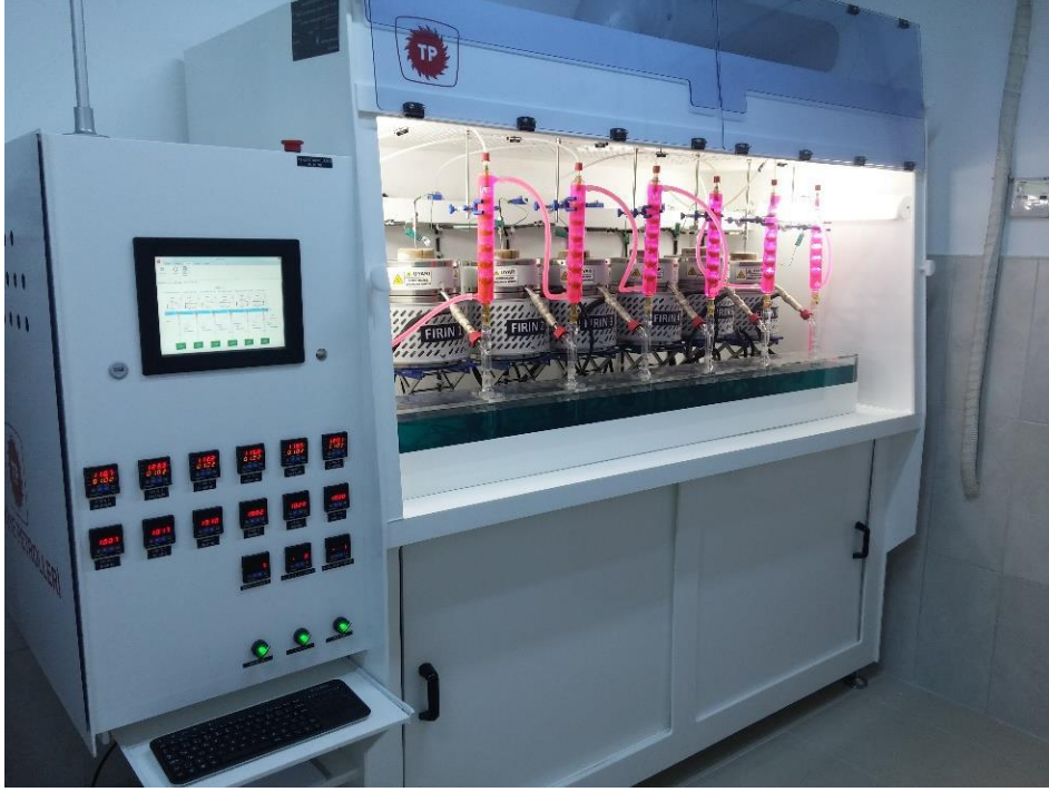
Şekil 3.4 TPAO’da hizmet veren Modified Fischer Assay cihazı
