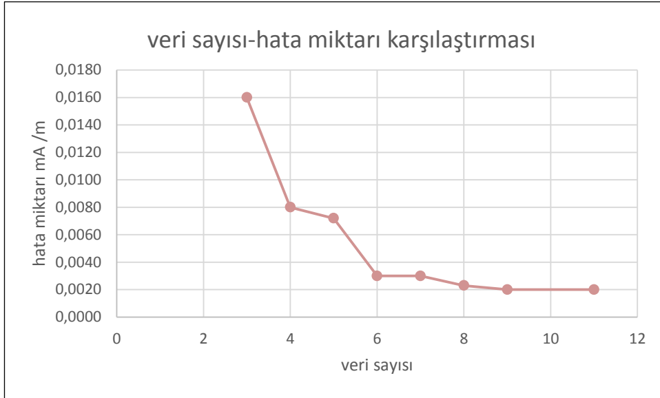
Şekil 7.43 15 W KFL için 601-900 MHz frekans aralığındaki manyetik alan veri sayısı hata miktarı karşılaştırması
