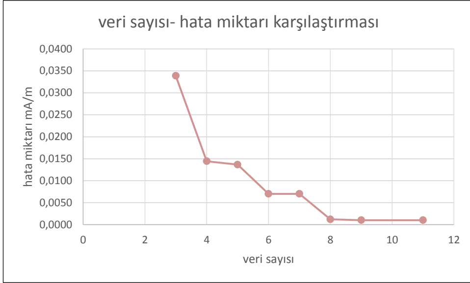
Şekil 7.42 15 W KFL için 301-600 MHz frekans aralığındaki manyetik alan veri sayısı hata miktarı karşılaştırması
