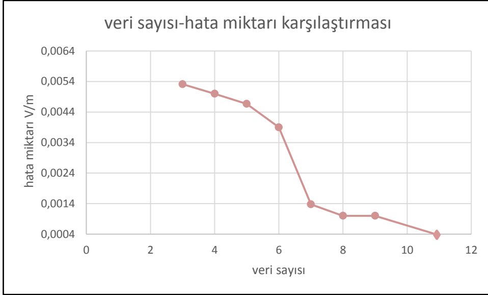
Şekil 7.32 8 W KFL için 50-300 MHz frekans aralığındaki elektrik alan veri sayısı hata miktarı karşılaştırması
