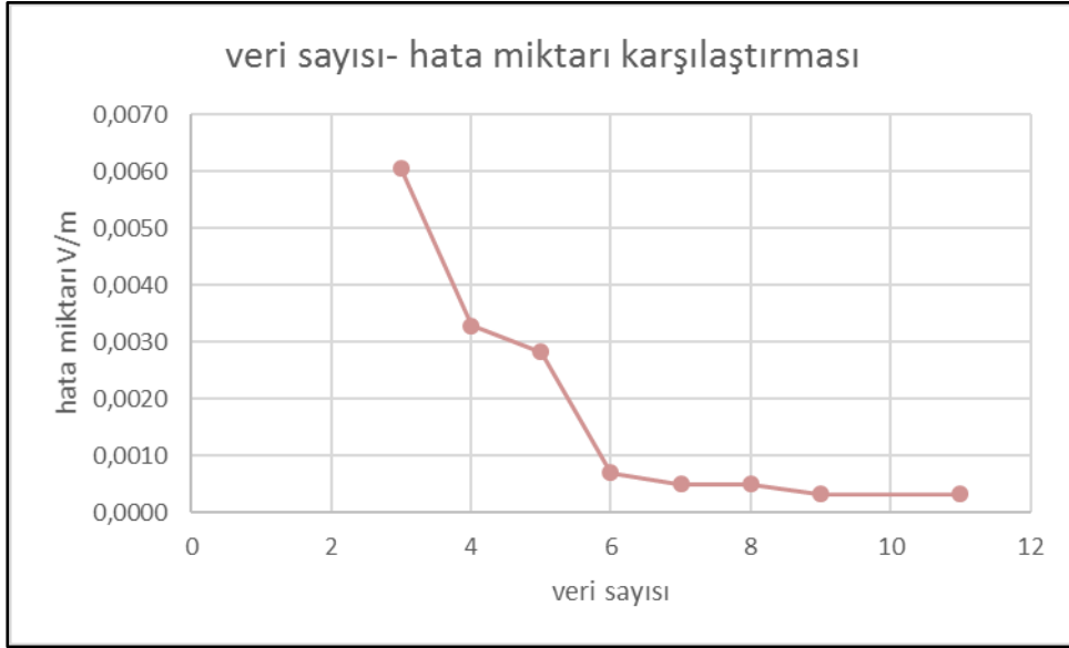
Şekil 7.50 50 W KFL için 301-600 MHz frekans aralığındaki elektrik alan veri sayısı hata miktarı karşılaştırması
