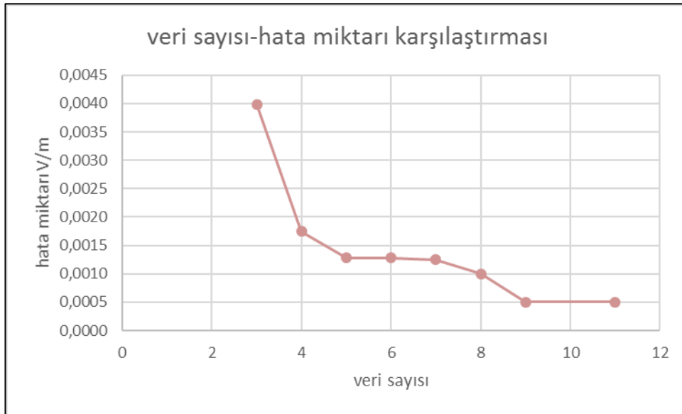
Şekil 5.57 73 W KFL için 601-900 MHz frekans aralığındaki elektrik alan veri sayısı hata miktarı karşılaştırması
