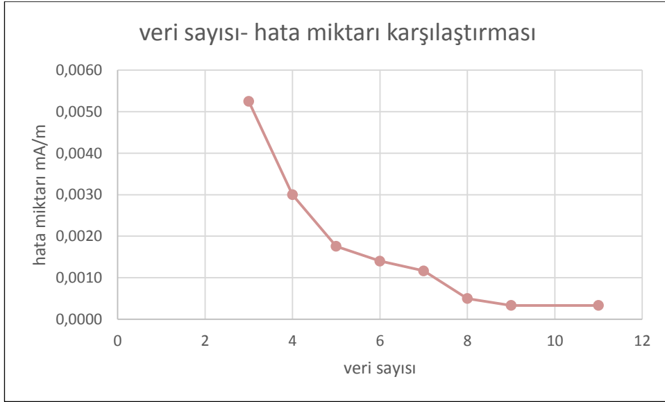
Şekil 7.47 30 W KFL için 301-600 MHz frekans aralığındaki manyetik alan veri sayısının hata miktarı karşılaştırması
