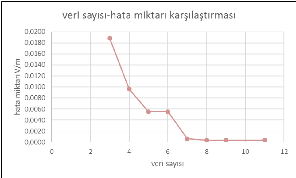
Şekil 7.39 15 W KFL için 301-600 MHz frekans aralığındaki elektrik alan veri sayısı hata miktarı karşılaştırması
