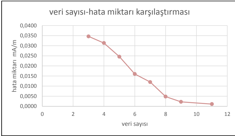
Şekil 7.35 8 W KFL için 50-300 MHz frekans aralığındaki manyetik alan veri sayısı hata miktarı karşılaştırması
