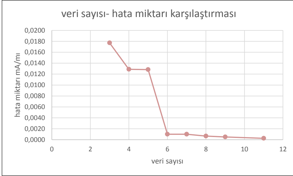
Şekil 7.54 50 W KFL için 601-900 MHz frekans aralığındaki manyetik alan veri sayısı hata miktarı karşılaştırması
