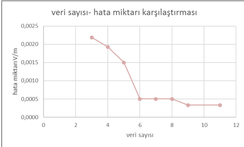
Şekil 7.49 50 W KFL için 50-300 MHz frekans aralığındaki elektrik alan veri sayısı hata miktarı karşılaştırması
