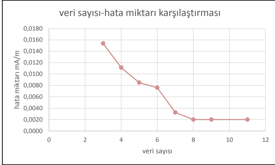
Şekil 7.52 50 W KFL için 50-300 MHz frekans aralığındaki manyetik alan veri sayısı hata miktarı karşılaştırması
