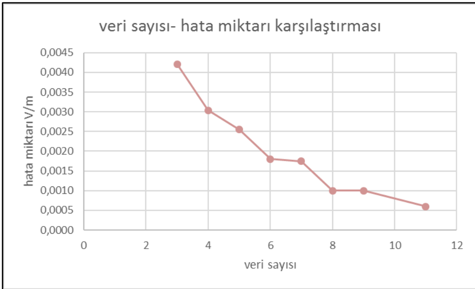
Şekil 7.51 50 W KFL için 601-900 MHz frekans aralığındaki elektrik alan veri sayısı hata miktarı karşılaştırması
