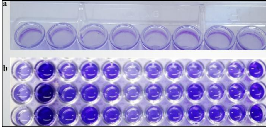
Şekil 3.2.a. Çeperlerdeki biyofilm matrikslerine tutunmuş kristal viyole boyası, b. Tutunmuş boyanın organik çözücülerle muamele edilmiş hali
