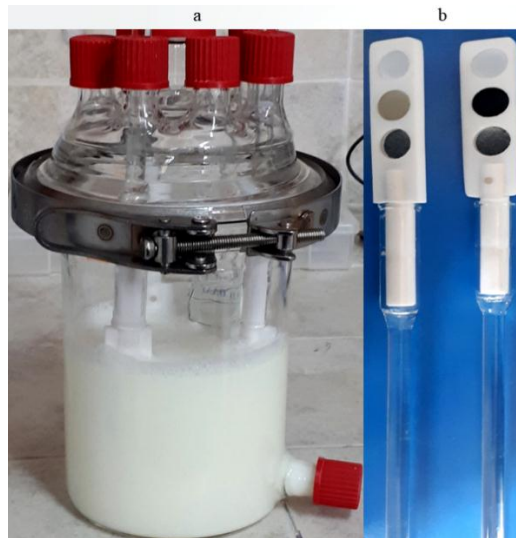
Şekil 3.6.a Çalıştırılmaya hazır reaktör, b. Farklı abiyotik yüzeyleri tutan taşıyıcılar
