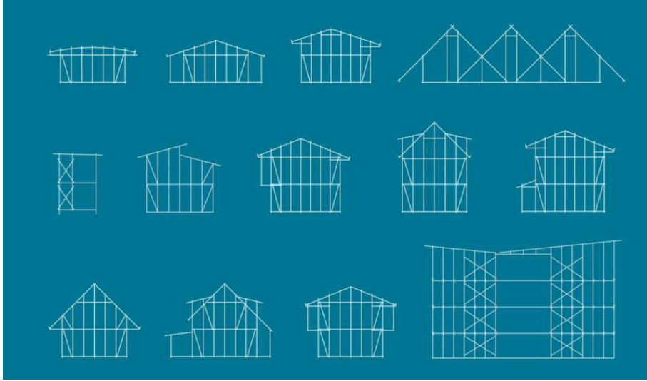
Şekil 5: HSIEH ve ekibi tarafından, konutların temel planlamasını ve yeniden yapılanma çalışmalarında uygulanabilir çelik çerçeve düzenini göstermek için üretilen tek çizgi mimari çizimler. Kaynak: Atelier-3.
