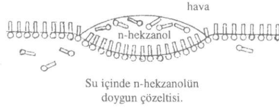
Şekil 24. Su yüzeyinde n-hekzanolün yayılması.
