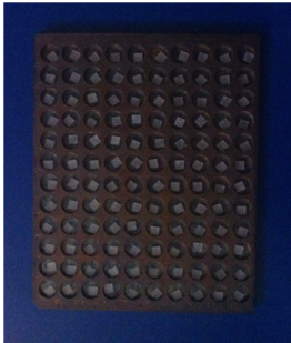
Şekil 2.11: Bakır taşıma kabına yerleştirilmiş Termoluminesans Dozimetreler ( TLD-100)
