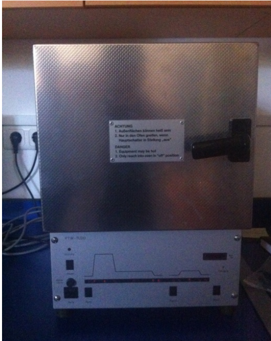
Şekil 2.13: TLD'lerin ısıtılmasında kullanılan fırın
