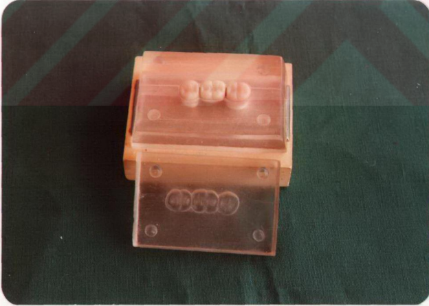
Resim 3.16: Standart köprülerin hazırlanmasında kullanılan üç parçalı akrilik kalıpla elde edilen fırınlanmış porselen köprü
