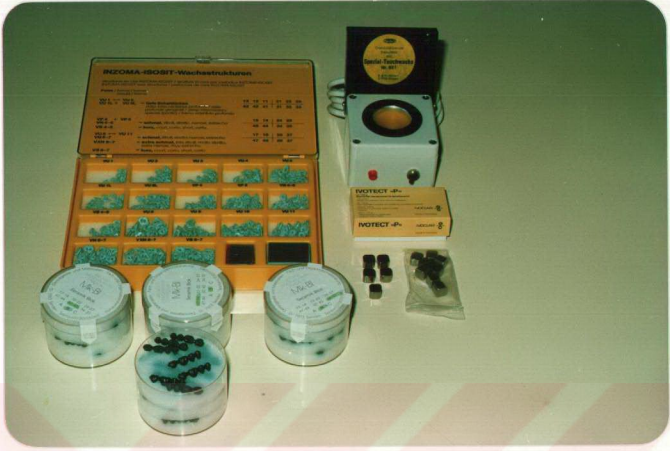
Resim 3.6: Inzoma, delikli mum gövde formları (Ivoclar) Mk,B1 seramik blok, dolu mum gövde formları (Bredent), Hotty mum eritme cihazı (Ivoclar) Ivotect P Nikel-Krom alaşımı (Ivoclar)
