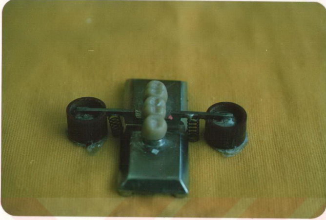
Resim 3.20: Köprülerde yüklemeye bağlı oluşan esnemeyi tesbit edebilmek için kullanılan, yaylı bir destek ve tüpler içinde karbon pullar ihtiva eden düzenek
