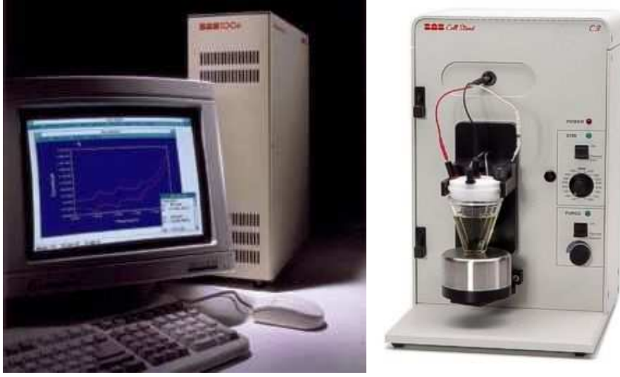
Şekil 3.1 Çalışmanın yapıldığı elektrokimyasal sistem: Bioanalytical Systems Electrochemical Analyzer BAS 100B cihazı ve BAS C3 elektrot hücre standı
