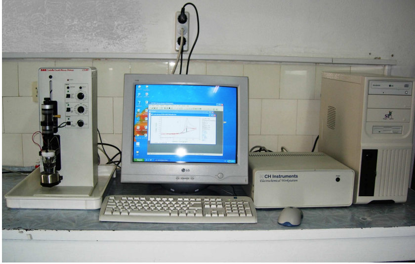
Şekil 3.2 Çalışmanın yapıldığı elektrokimyasal sistem: CH Instruments Electrochemical Workstation CHI760B ve BAS CGME hücre standı
