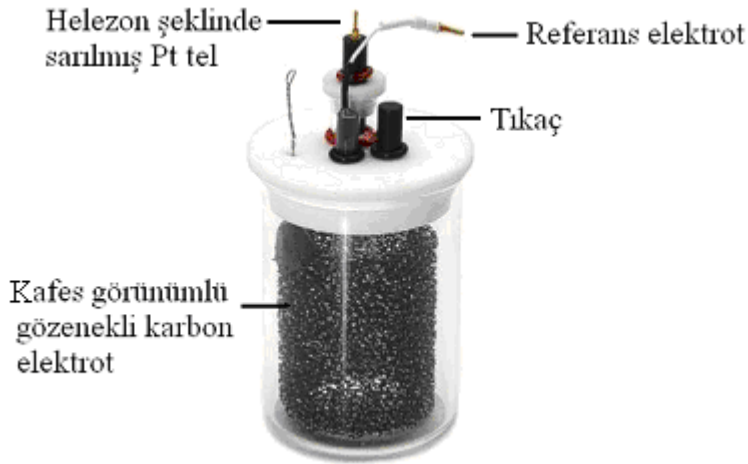
Şekil 3.3 Elektrokimyasal Sistem BAS 100B cihazına ait sabit potansiyelli kulometri çalışmaları için bulk elektroliz hücresi
