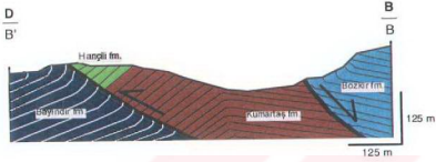
Şekil 3.20. EK 1'de jeoloji haritası üzerindeki B'B hattı boyunca alınmış jeolojik kesit
