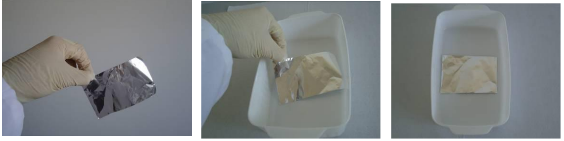
Resim 2.11 Metal plakanın tatlı ve tuzlu su altında bekletilmek üzere kap içerisine yerleştirilmesi
