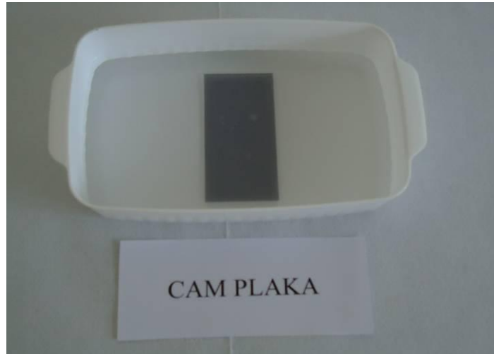
Resim 2.12 Cam plakanın tatlı ve tuzlu su altında bekletilmesi
