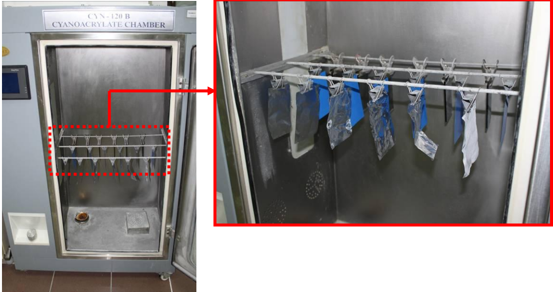
Resim 2.16 Materyallere supergule (siyanoakrilat) yönteminin uygulanması (Parmak İzi Laboratuvarı, JKDB)
