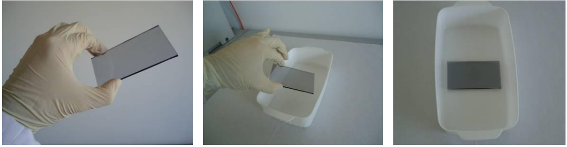
Resim 2.9 Cam plakanın tatlı ve tuzlu su altında bekletilmek üzere kap içerisine yerleştirilmesi
