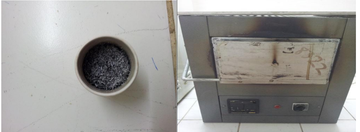
Şekil 3.18 Çeltik kavuzlarının kül fırınında yakılması
