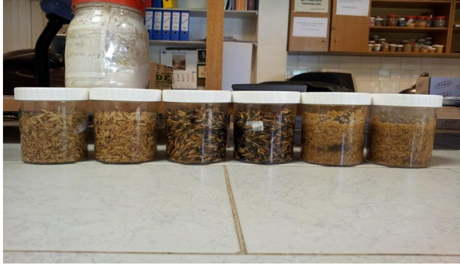
Şekil 3.20 Doğal, öğütülmüş ve karbonize çeltik kavuzlarının EC ve pH değerlerinin ölçümü
