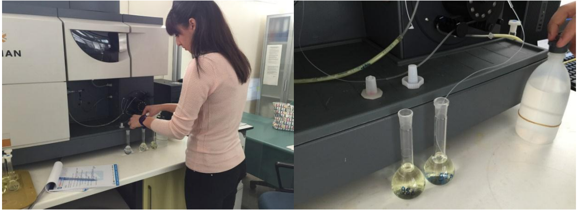
Şekil 3.34 ICP-OES'de besin elementi ölçümü
