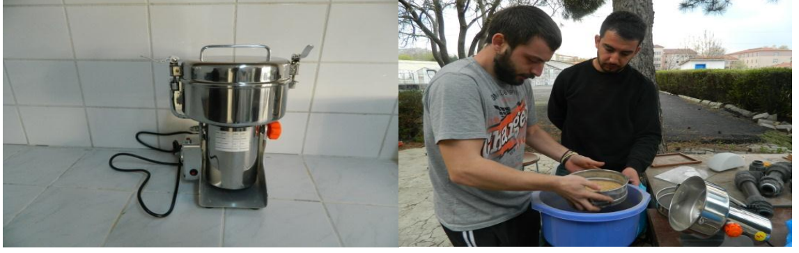
Şekil 3.6 Çeltik kavuzunun öğütülmesi ve elenmesi
