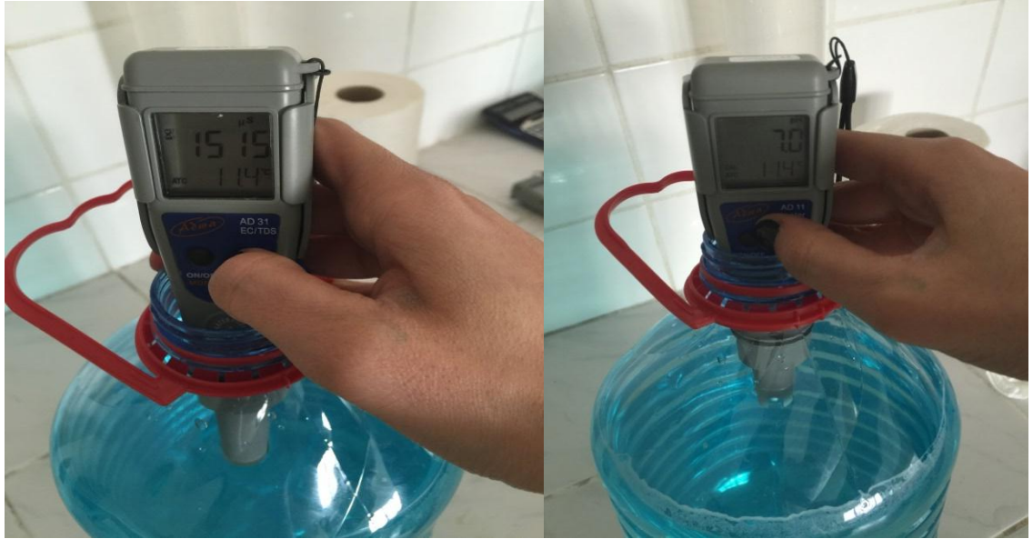
Şekil 3.10 Besin solüsyonlarının EC ve pH ölçümleri
