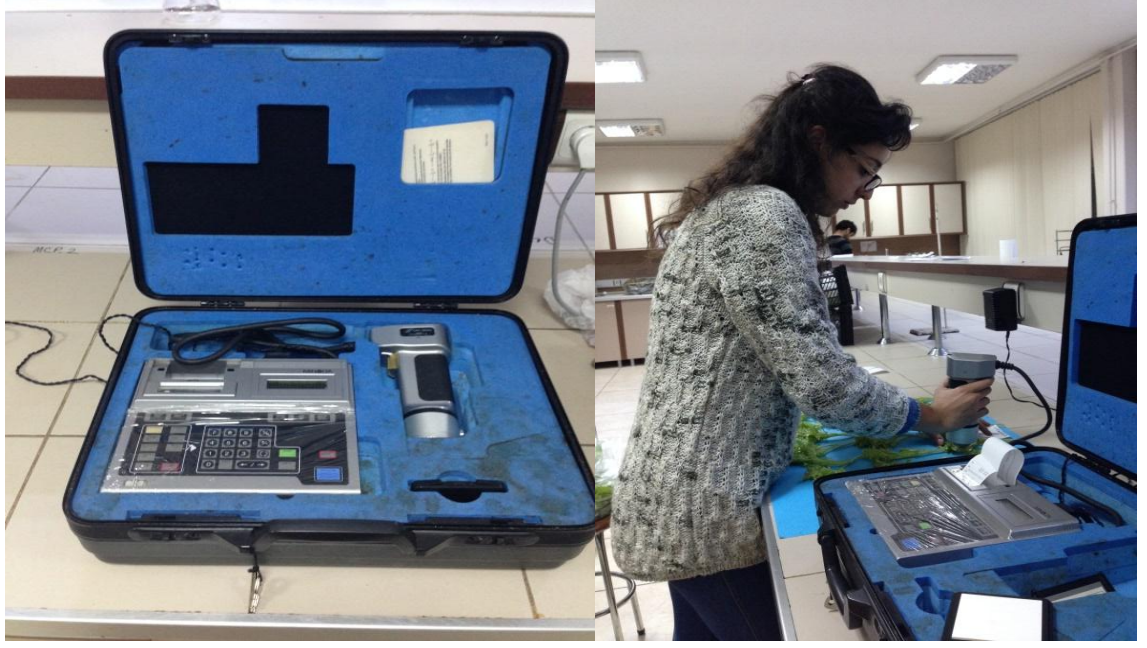
Şekil 3.28 Minolta CR200 renk ölçer ve renk ölçüm işlemi
