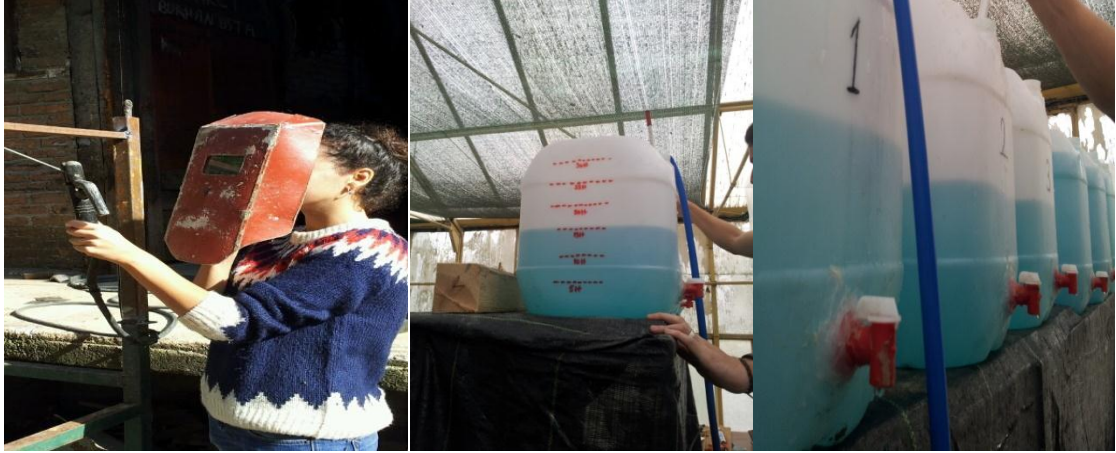
Şekil 3.8 Besin solüsyonunun içerisine konulduğu beyaza boyalı plastik bidon ve yerleştirildiği sehpanın yapımı
