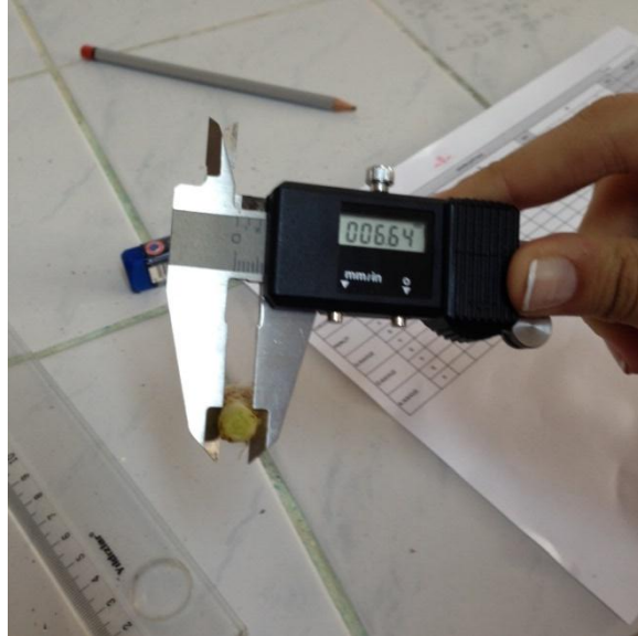
Şekil 3.22 Gövde çapı (mm)'nin kumpas yardımıyla ölçümü
