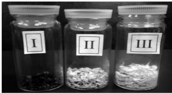
Şekil 3.12 Değişik katalizör sistemleri kullanıldığında PLLA'daki renk değişimi I : SnCl 2 ·2H 2 O; II: SnCl 2 ·2H 2 O- p-TSA; III: SnCl 2 ·2H 2 O-Ge(OEt) 4 (180°C, 10 mmHg, 15 saat)
