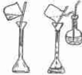
Şekil-31: Çözelti hazırlamada tartı kabının yıkama eriyi- şe dahil edilişi.
